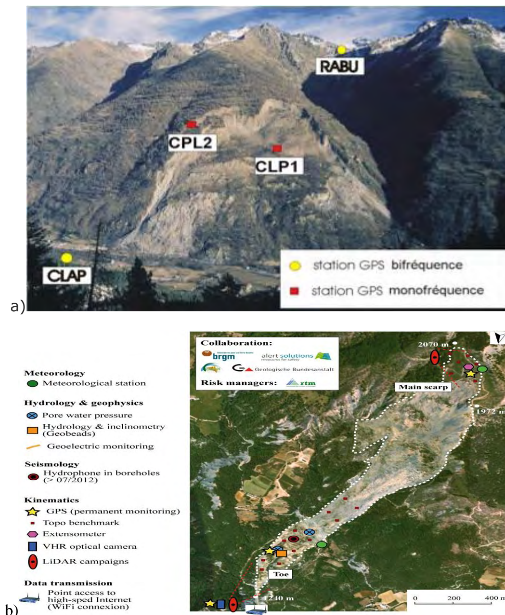
Figure 13 : Localisation des différents instruments de surveillance des glissements de La Valette(b) et de La Clapière(a)(OMIV).
